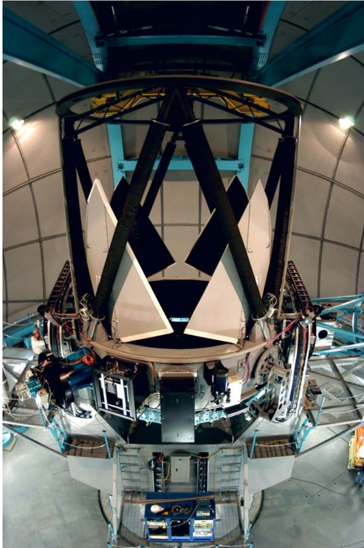
Duas visões do SOAR. Pode-se ver na esquerda a montagem altazimutal e na direita os atuadores hidráulicos da óptica ativa.
