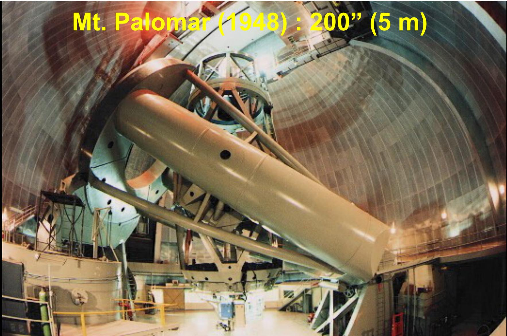
**Montagem análoga a Mt. Wilson: equatorial em ferradura com dois pés. Até os anos 70 foi o maior telescópio do mundo. O telescópio russo de 6m construído nos anos 70 nunca funcionou direito e este aqui foi na prática o maior do mundo até a entrada em operação dos telescópios da classe de 8-10 m como o Gemini, VLT ou Keck.**
