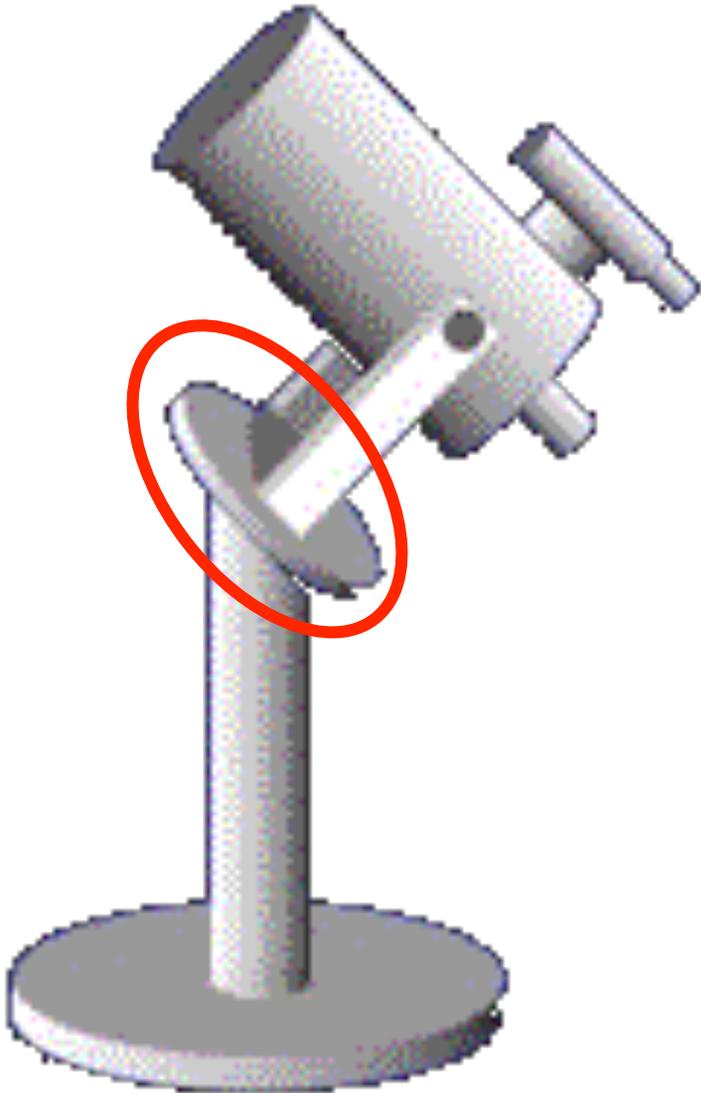
O Telescópio é instalado dentro de uma ferradura que gira centrada no eixo polar. Deve-se notar que toda a carga mecânica da parte móvel é exercida na junção da ferradura com o pilar
