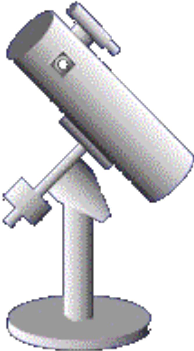
O Telescópio é instalado na extremidade de um eixo ortogonal ao eixo polar. Na outra extremidade do eixo é instalado um contrapeso
