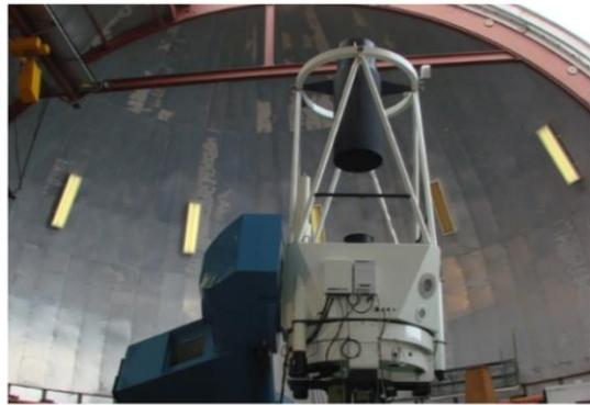
Cúpula do telescópio de 1,6m do OPD/LNA, utilizado em trabalhos de fotometria, polarimetria e espectroscopia. Créditos: OPD/LNA
