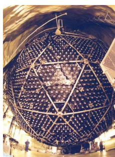
Figura 3.5: Observatório de Neutrinos de Sudbury, em Ontario, Canadá. Trata-se de uma esfera de 12 m, enterrado 2,1 quilômetros abaixo do solo em uma velha mina
