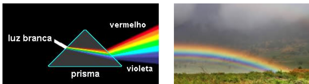
Figura 2.3: Passagem da luz branca por um prisma.
