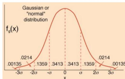
Figure: distribuição gaussiana; mostra-se as frações da área em intervalos de  $\sigma$
