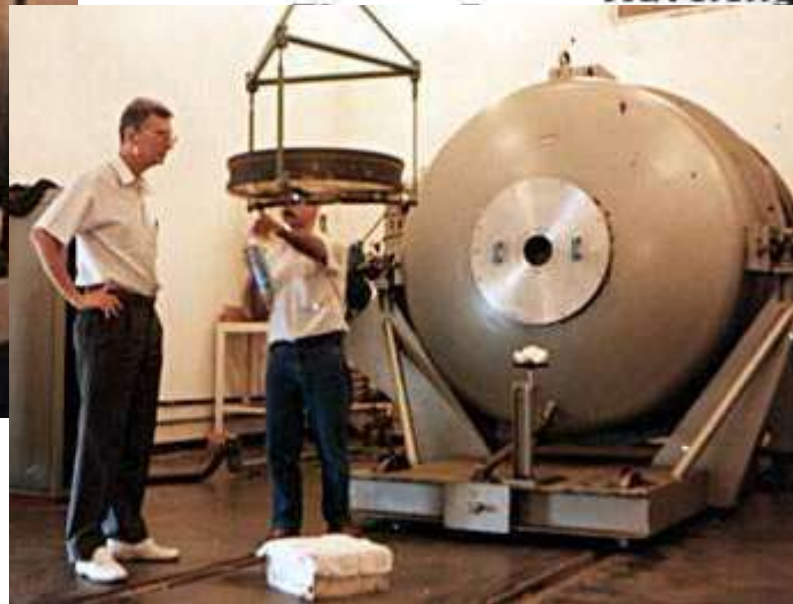
Aluminizado tel. 0.6m da Serra da Piedade no LNA
