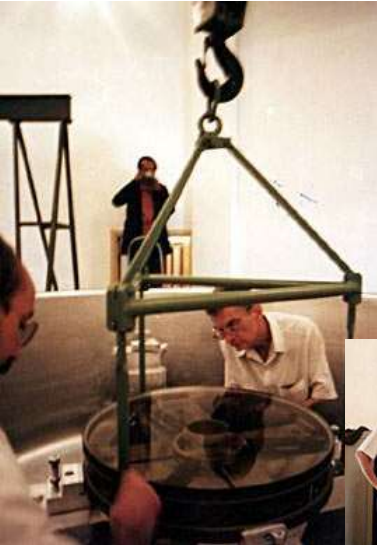
Aluminizado tel. 0.6m da Serra da Piedade no LNA
