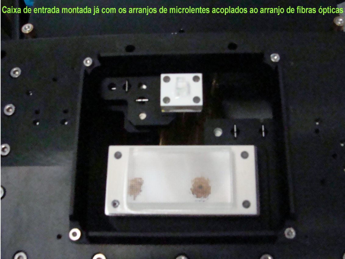
Caixa de entrada com arranjo de entrada de luz nas fibras ópticas
