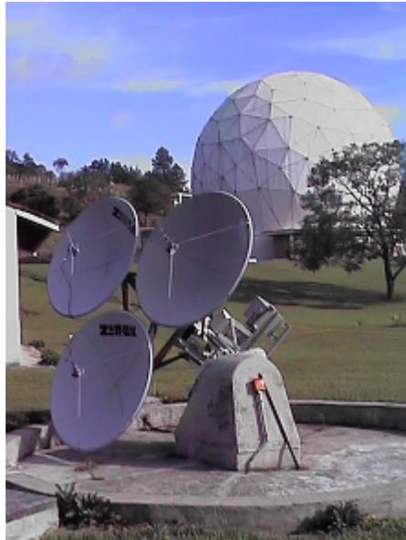
Figura 3 - Telescópio robotizado solar em 12 GHz - SPUA (Solar Patrol Un-phased Array) à frente e ao fundo o Rádio Telescópio do Itapetinga
