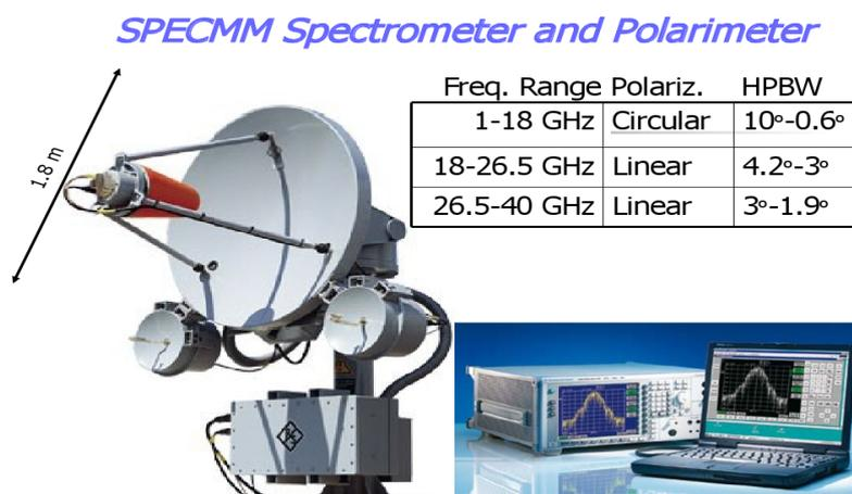
Figura 4 - Espectrômetro solar de banda larga em 1-40 GHz, SPECMM
