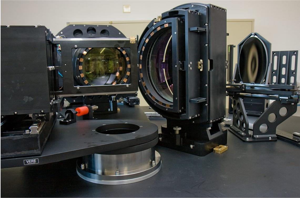
Caixa de entrada montada já com os arranjos de microlentes acoplados ao arranjo de fibras ópticas
