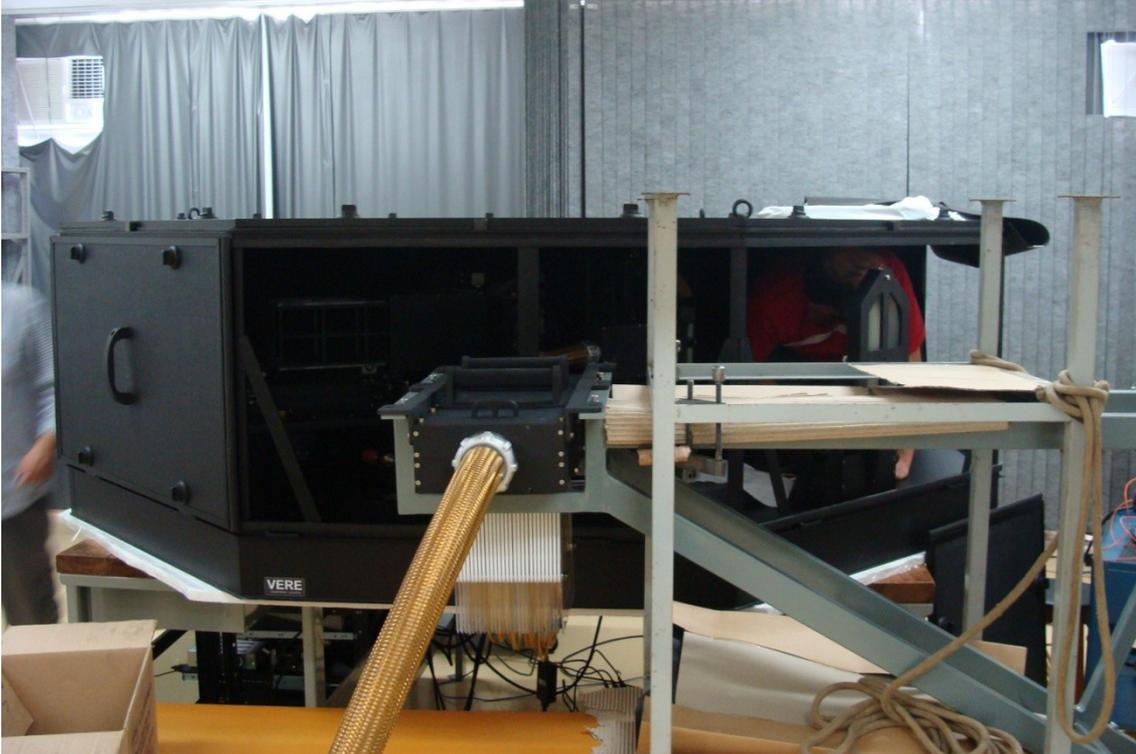
Detalhe visual das fibras ópticas dentro da caixa de alívio de tensão
