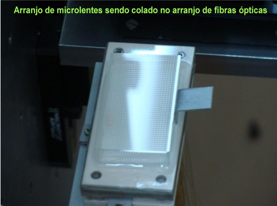
Imagem em foco do arranjo de microlentes alinhadas com o arranjo de fibras ópticas correspondente
