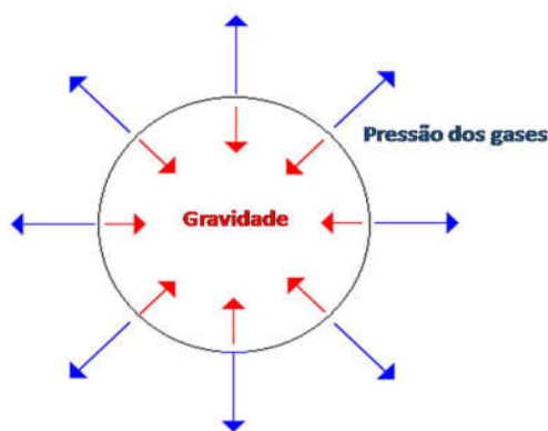
Figura 8.6 – Equilíbrio hidrostático. A força de pressão dos gases (que tenderia a fazer a estrela se expandir) é precisamente equilibrada pela força gravitacional (que tenderia a fazer a estrela se contrair). Como resultado do equilíbrio, a estrela se mantém estável. (Crédito: NASA.)
