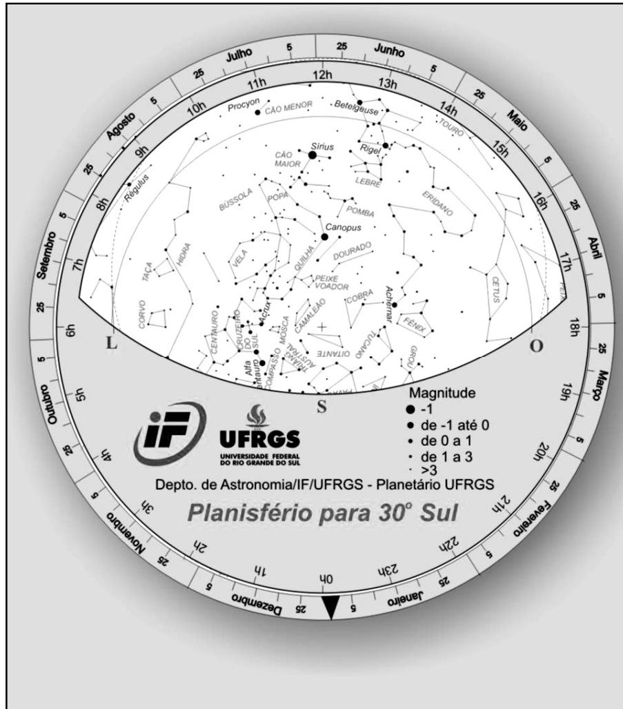
Figura 3.6 – Planisfério celeste projetado para a latitude 30° Sul. Notar os dois círculos graduados com os meses do ano de janeiro a dezembro e as horas entre 0h e 24h. Ajustando-os para a data e a hora da observação, tem-se uma boa reprodução do aspecto do céu local (Crédito: M.F. Saraiva, UFRGS.)
