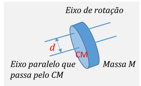
7 - Rotação em torno de um eixo fora do centro de massa (CM).
